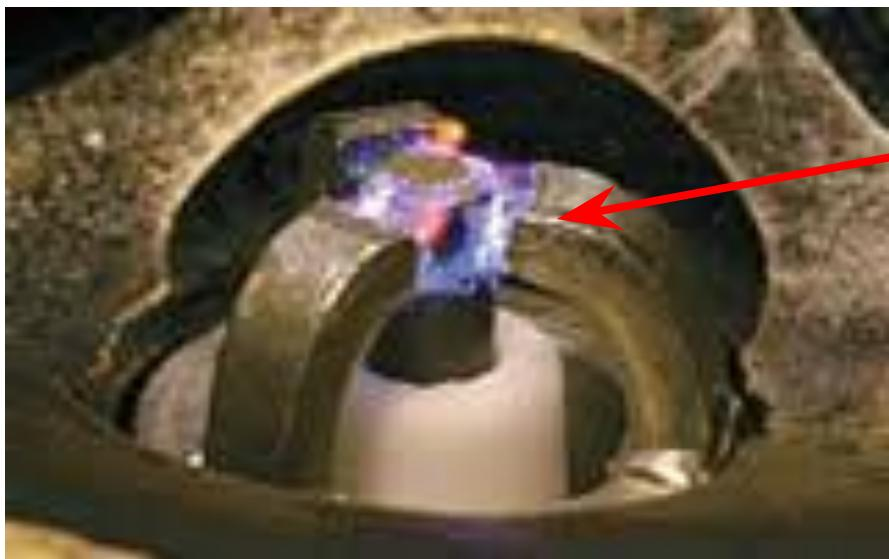
Образование искрового разряда в камере сгорания ДВС
