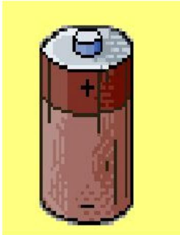
В гальваническом элементе происходят химические реакции, и внутренняя энергия, выделяющаяся при этих реакциях превращается в электрическую.
