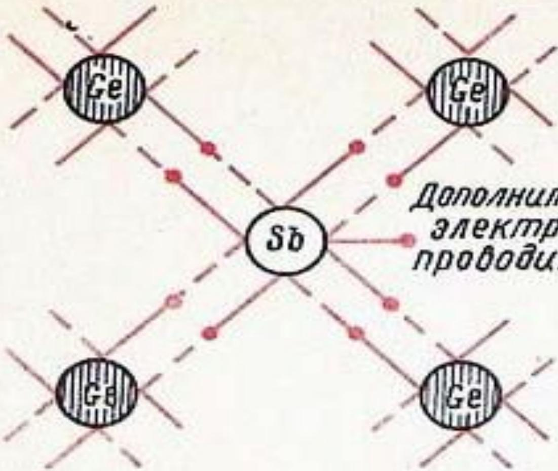
Дополнительный электрон проводимости
