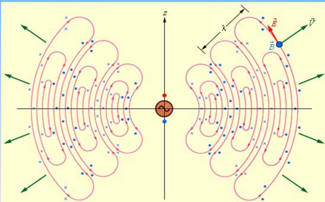
Структура электромагнитного поля диполя, совершающего гармонические колебания.
