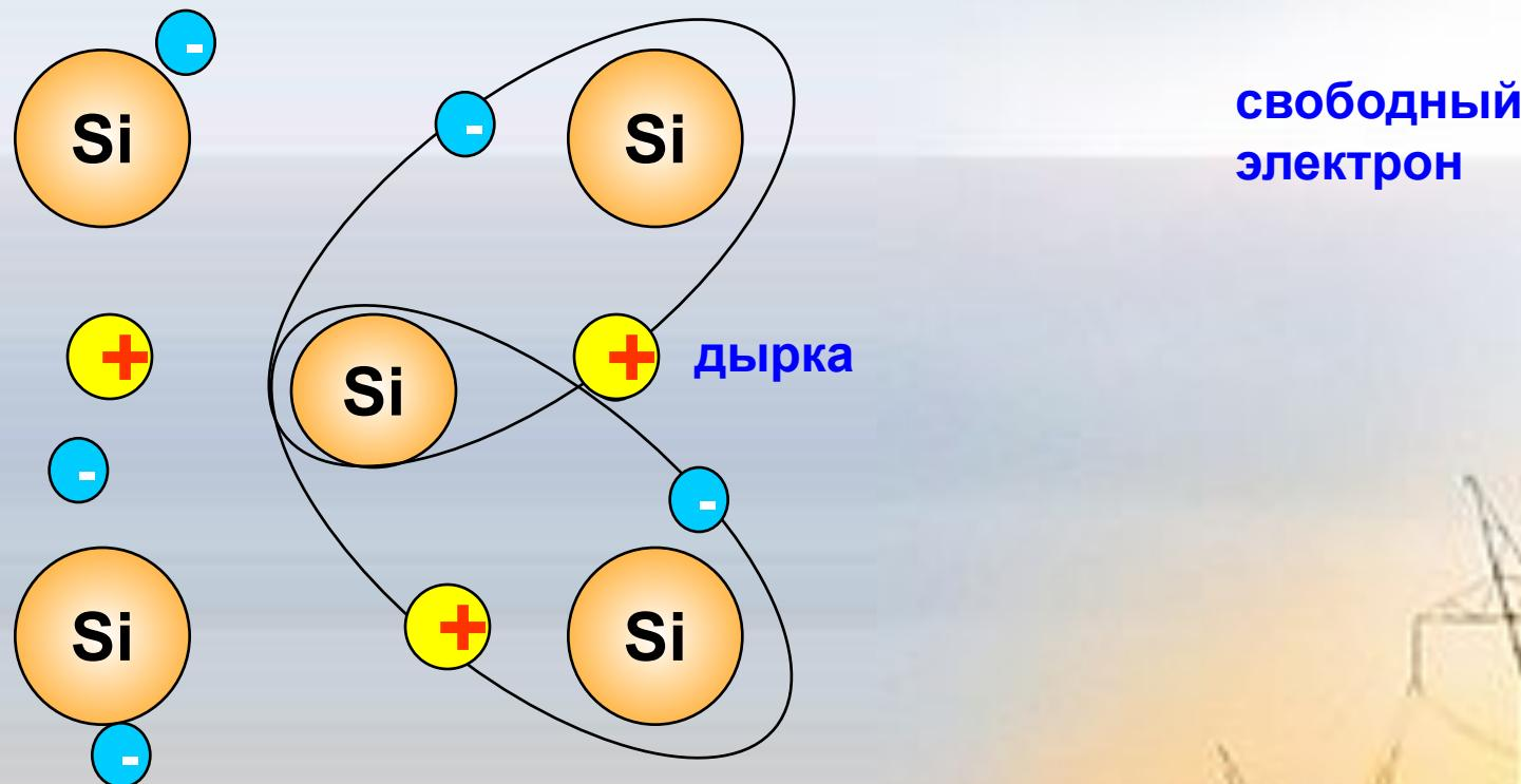
При увеличении температуры энергия электронов увеличивается и некоторые из них покидают связи, становясь **свободными электронами**. На их месте остаются некомпенсированные электрические заряды (виртуальные заряженные частицы), называемые **дырками**.
