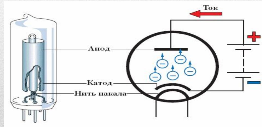
Термоэлектронная эмиссия (эффект Ричардсона, эффект Эдисона) — явление испускания электронов нагретыми телами.
