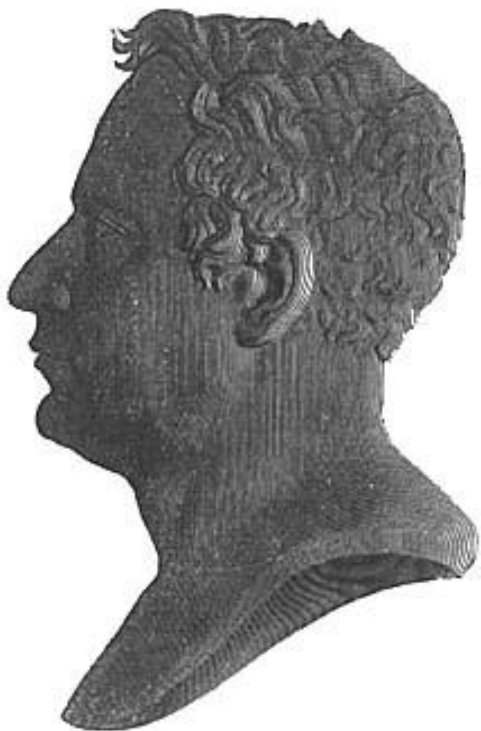
Копия барельефа, полученная методом гальванопластики
