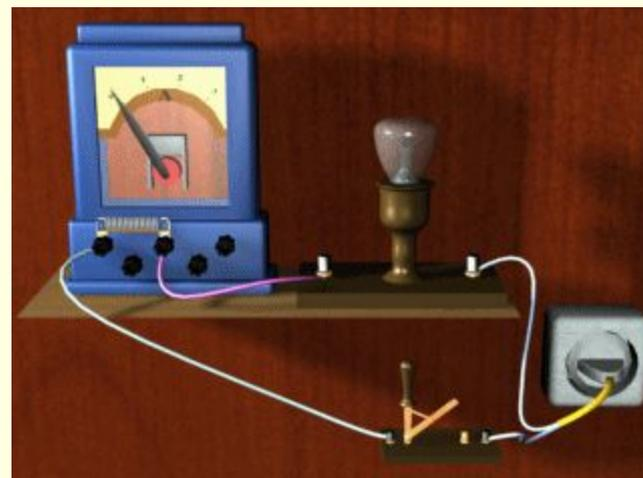
Объясняется это тем, что при одинаковой силе тока работа при перемещении электрического заряда, равного 1 Кл, различна.
