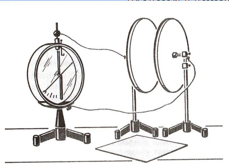
Если приблизить друг к другу две проводящие пластины, размеры которых много больше расстояния между ними, и подключить их к источнику напряжения, то можно считать, что поле, создаваемое каждой из пластин, приближенно совпадает с полем бесконечной пластины. Тогда внутри получившегося плоского конденсатора (между пластинами) поле будет равно сумме полей, создаваемых каждой пластиной:
