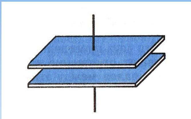
Простейший конденсатор состоит из двух плоскопараллельных пластин, находящихся на малом расстоянии друг от друга. Если заряды пластин одинаковы по модулю и противоположны по знаку, то силовые линии электрического поля начинаются на положительно заряженной обкладке
