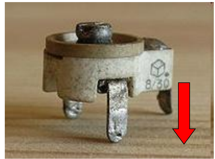
Керамический подстроечный конденсатор
