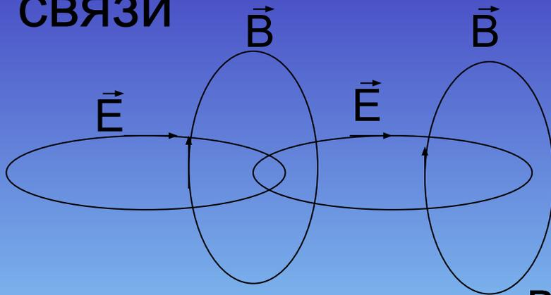
Источник электромагнитных волн – ускоренно движущийся заряд ( $q$ )
