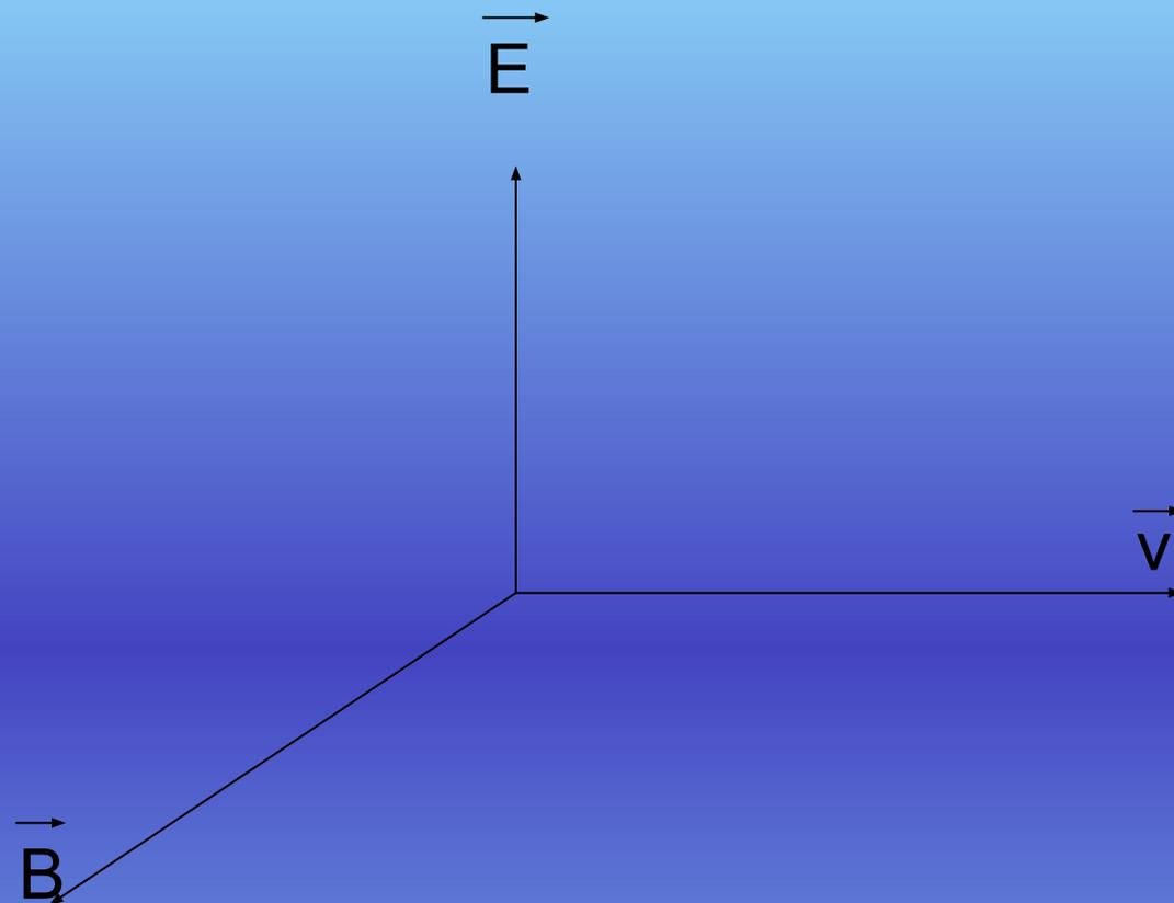
=> Электромагнитная волна поперечная
