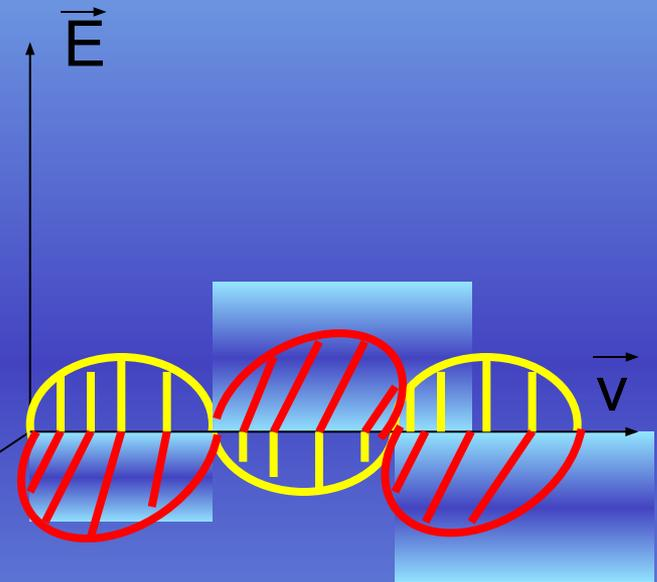
$$\begin{aligned}\vec{B} &\perp \vec{v} \\ \vec{E} &\perp \vec{B} \\ \vec{E} &\perp \vec{v}\end{aligned}$$
