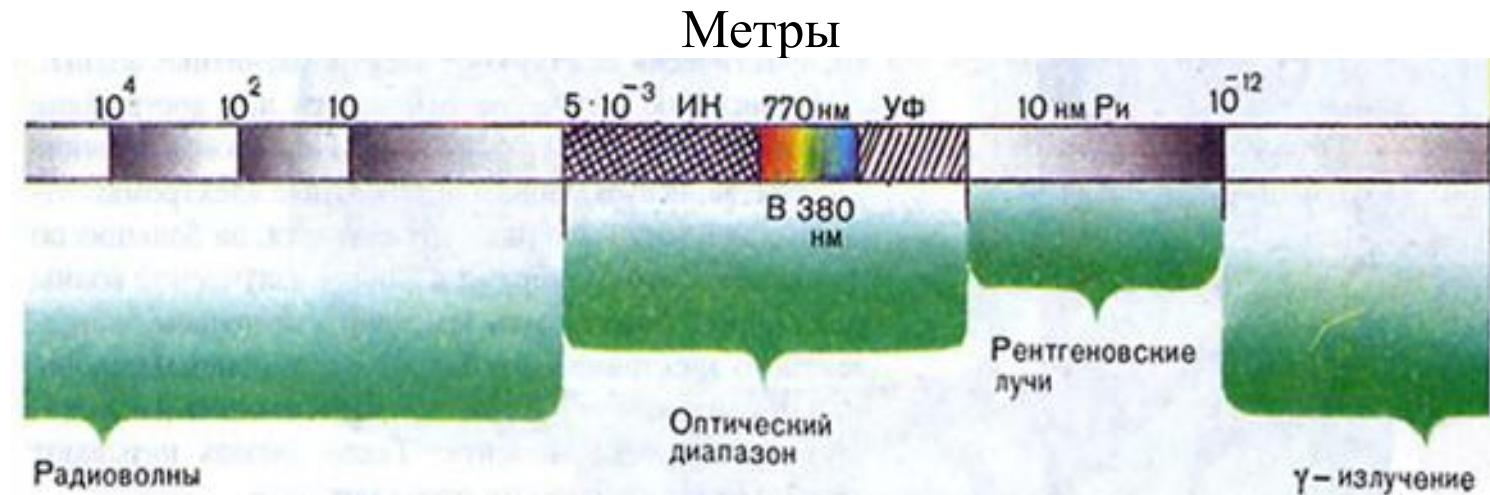
**Радиоволны**—это электромагнитные волны (с длиной волны от более чем 10000м до 0,005м), служащие для передачи сигналов (информации) на расстояние без проводов.
