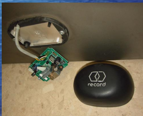
Инфракрасный датчик для дверей
