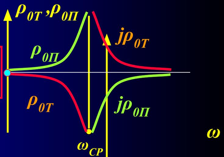
Для согласования реактивного фильтра нижних частот с нагрузкой сопротивление нагрузки на частоте  $\omega = 0$  выбирают равным характеристическому сопротивлению звена фильтра
