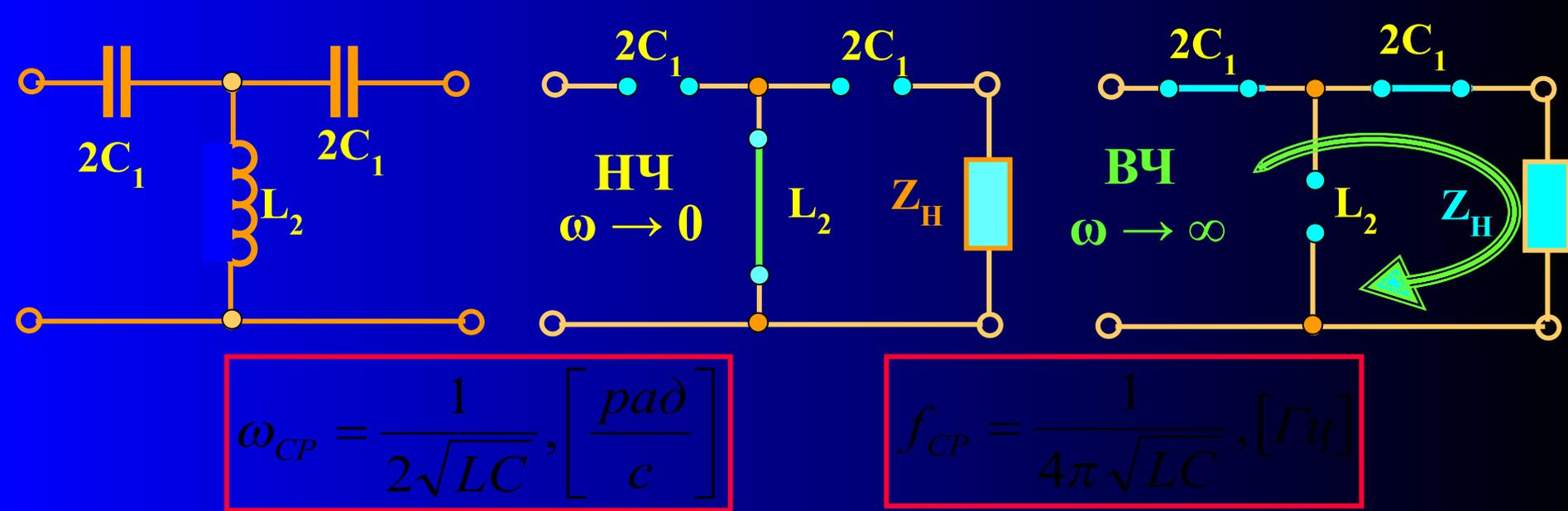
Полосовой пропускающий фильтр (ППФ) имеют полосу пропускания в некоторой области частот  $\omega_{CP1} \leq \omega \leq \omega_{CP2}$ , а полосу задерживания в области частот  $0 \leq \omega \leq \omega_{CP1}$  и  $\omega_{CP2} \leq \omega \leq \infty$ .
