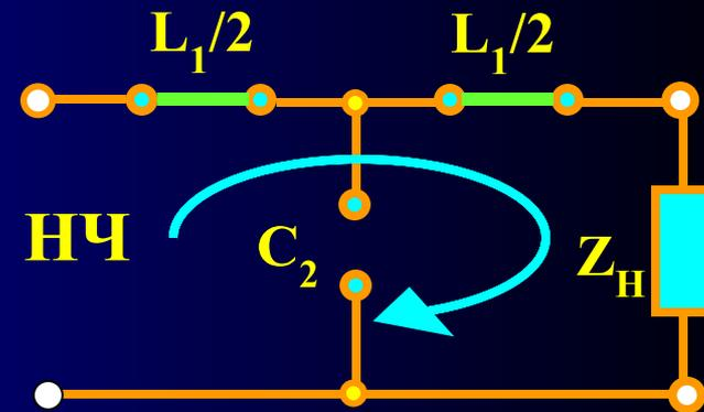
При  $\omega \rightarrow \infty$  индуктивность эквивалентна разрыву цепи, а емкость короткозамкнутому участку
