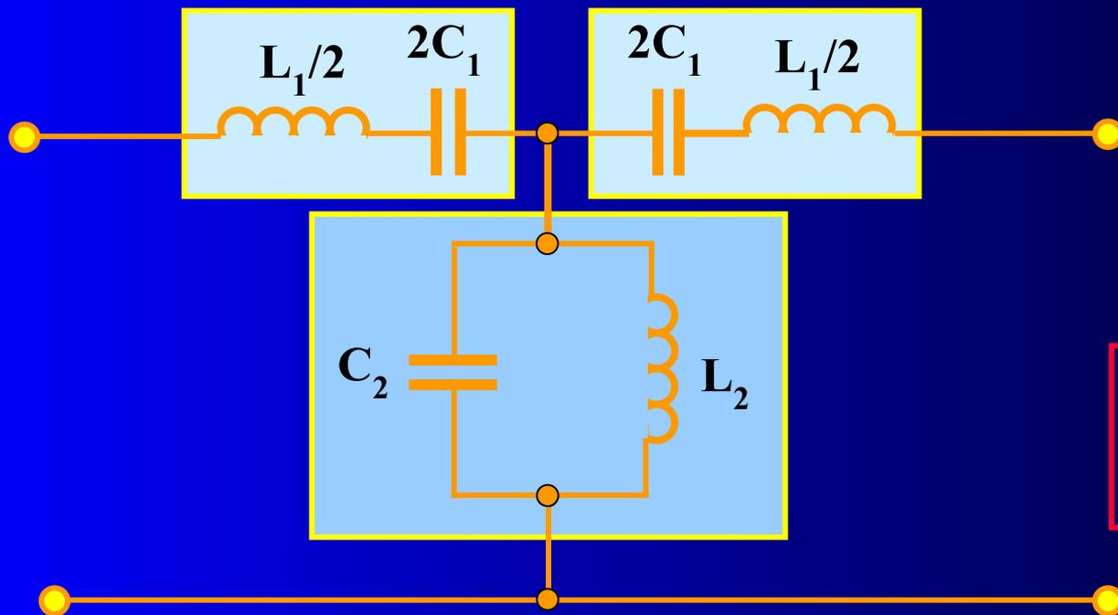
Резонансные частоты «продольного» и «поперечного» плеч ППФ одинаковы
