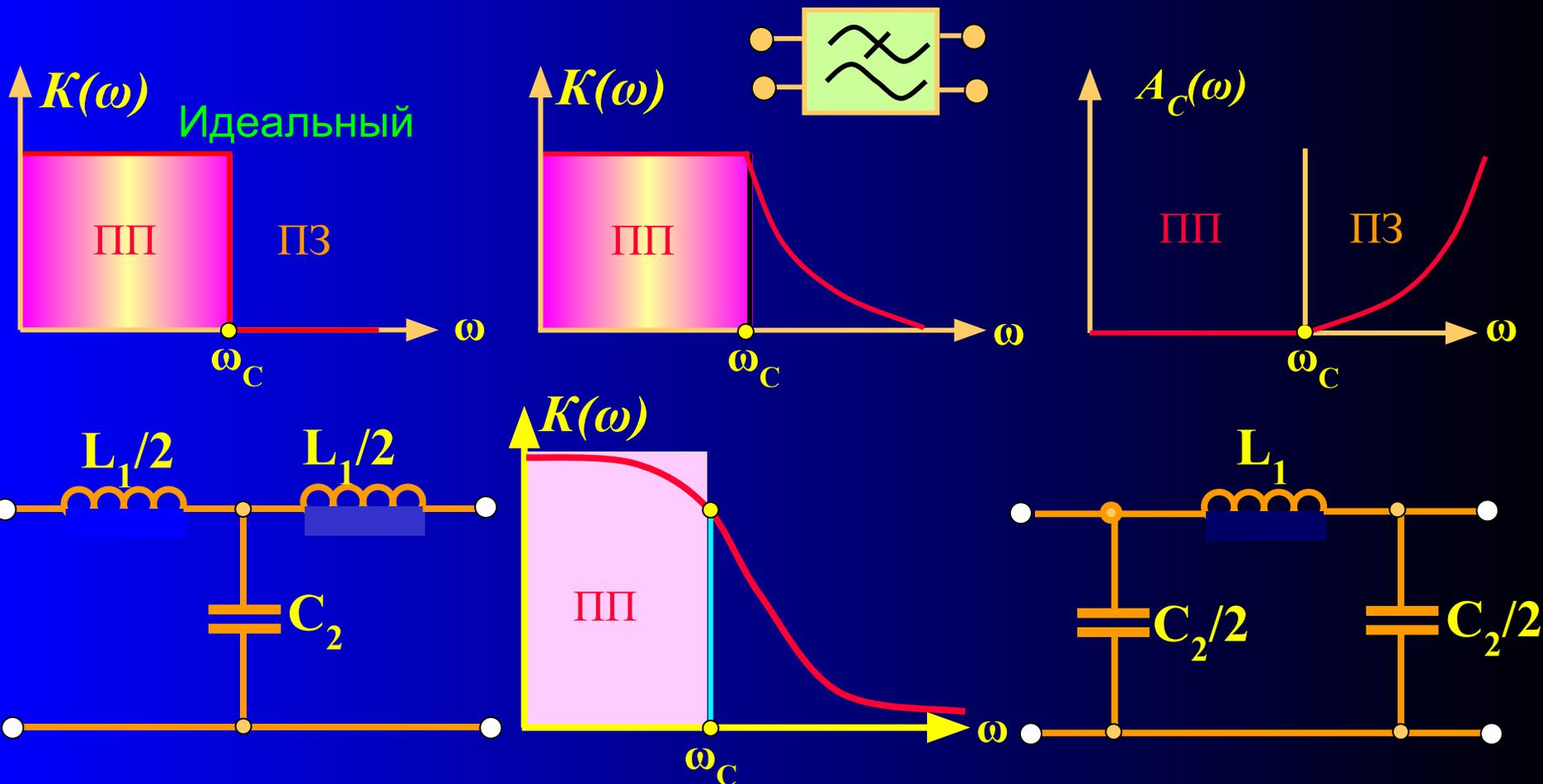
Рассмотрим физическую интерпретацию анализа Т – образной схемы ФНЧ при изменении частоты  $\omega \rightarrow 0$  и  $\omega \rightarrow \infty$ .
