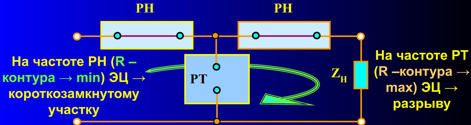
■ Полосовой заграждающий фильтр (ПЗФ) – режекторный фильтр (РФ) имеет полосу задерживания в некоторой области частот  $\omega_{CP1} \leq \omega \leq \omega_{CP2}$ , а полосу пропускания в области частот  $0 \leq \omega \leq \omega_{CP1}$  и  $\omega_{CP2} \leq \omega \leq \infty$ .
