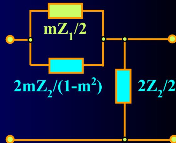
В таких фильтрах продольное или поперечное сопротивления изменяются таким образом, чтобы в пределах полосы пропускания звена фильтра одно из характеристических сопротивлений  $\rho_{0T}$  или  $\rho_{0П}$  практически не зависело от частоты, а другое остается равным характеристическому сопротивлению исходного звена *k мина*
