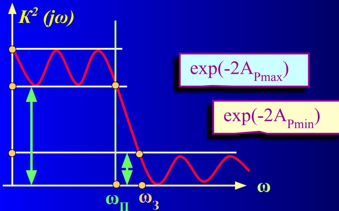
Частотные характеристики реальных фильтров могут приближаться к ним с той или иной степенью точности в зависимости от сложности схемы фильтра.
