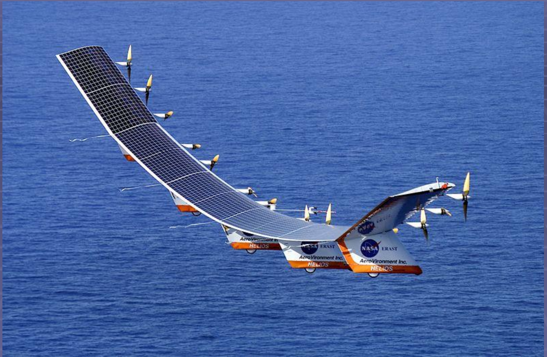
Беспилотный самолёт Helios с фотоэлементами на крыльях
