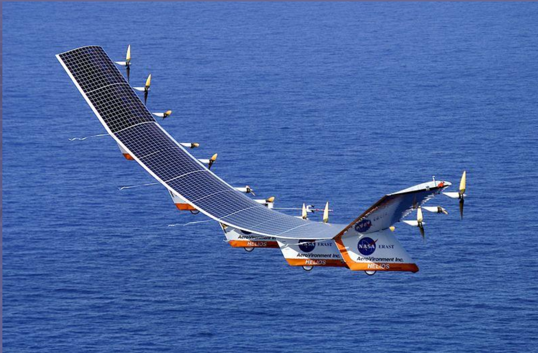
Беспилотный самолёт Helios с фотоэлементами на крыльях
