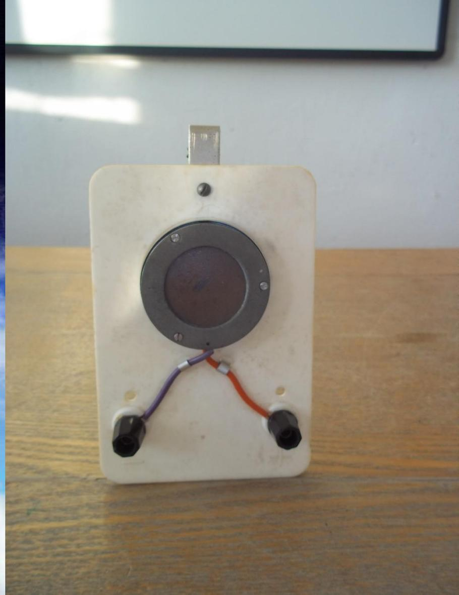
**Фотоэлемент преобразовывает световую энергию в электрический ток, посредством которого я и производила сравнение этих двух видов ламп**
