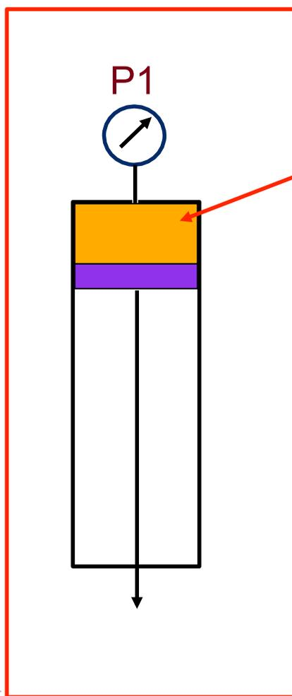
Однокомпонентная жидкость при давлении  $P_1$
