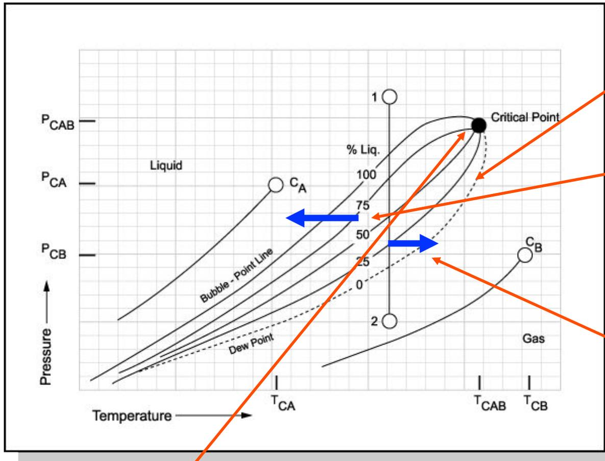
Разный состав смеси соответствует определенной форме двухфазной области.
