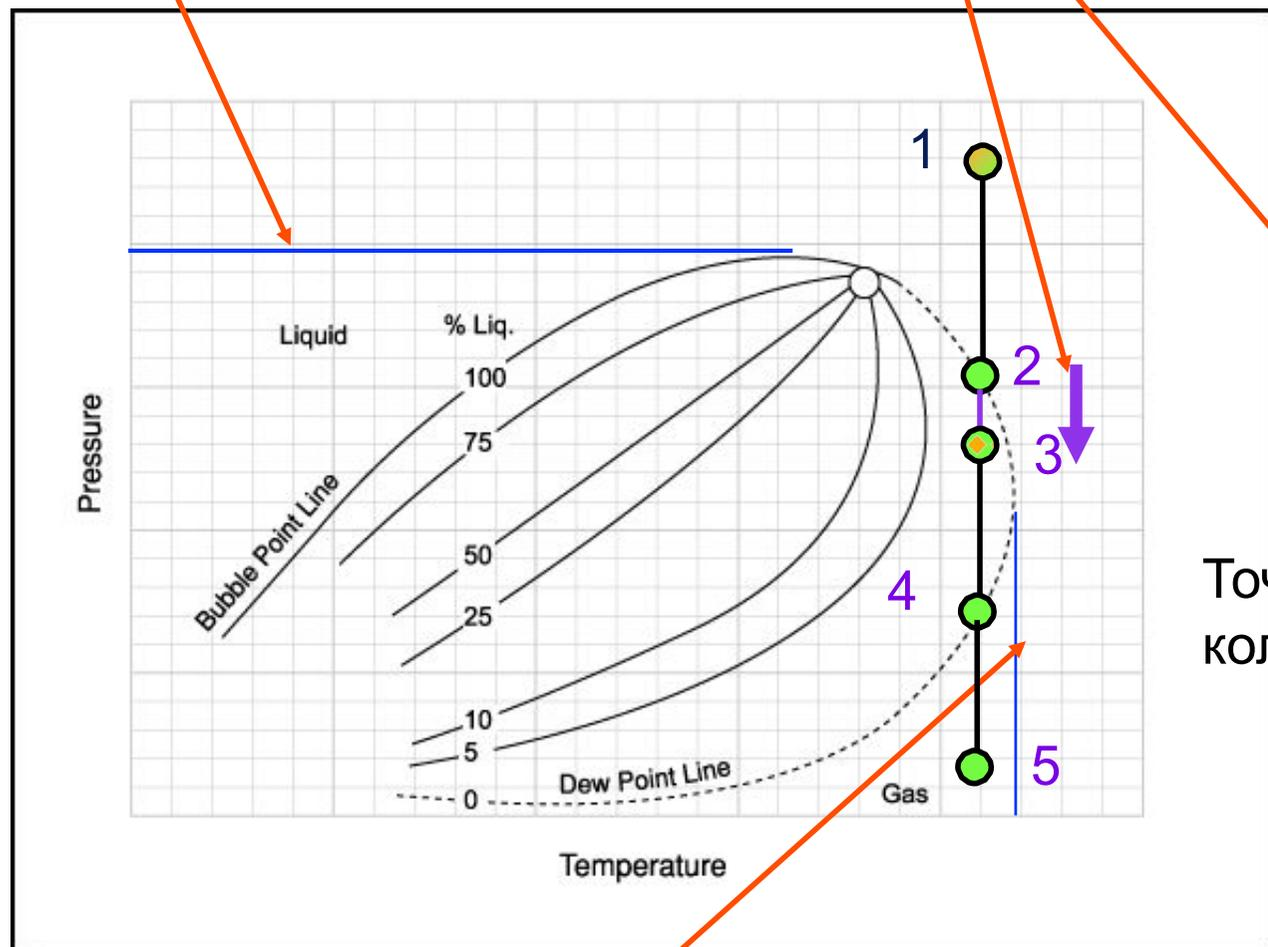
Поведение при постоянной температуре между критической температурой и крикоденбарой
