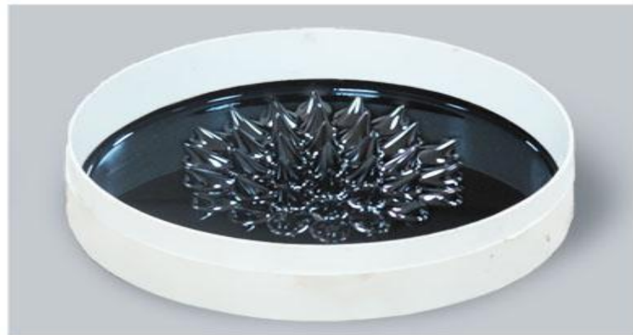
Ферромагнитная жидкость под воздействием слабого вертикального магнитного поля
