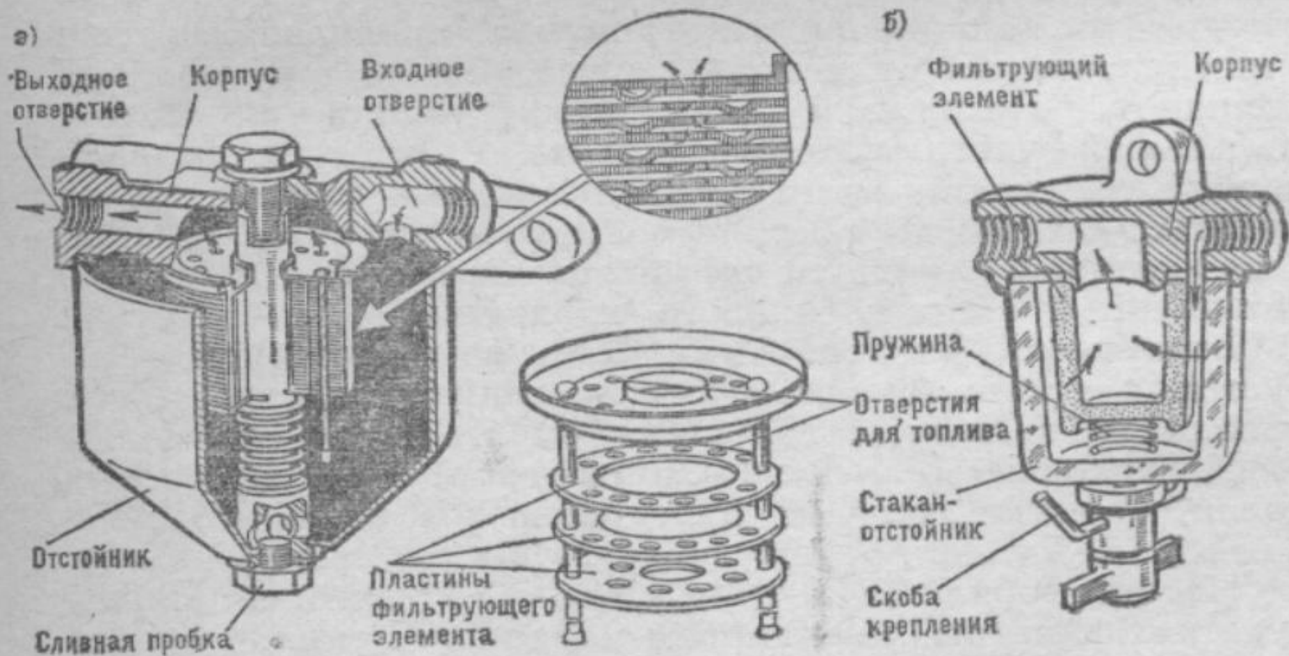
Рис. 21: Топливные фильтры карбюраторного двигателя: а — грубой очистки топлива; б — тонкой очистки топлива
