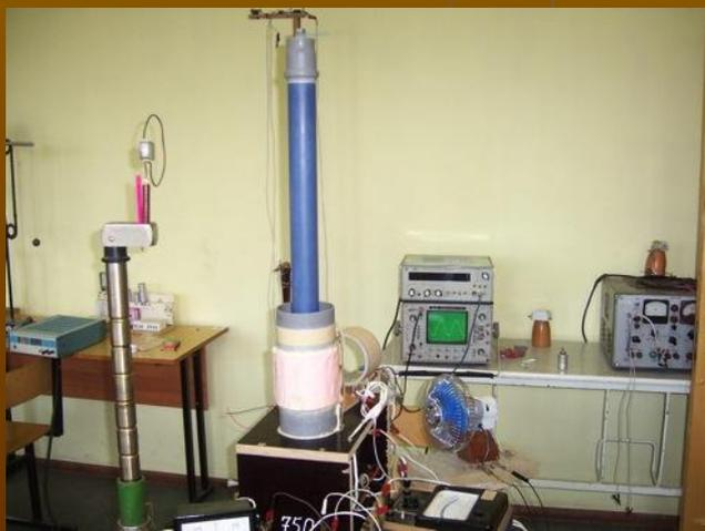
Долго ловили резонанс. Много конденсаторов сгорело. Долго настраивали сеточные токи, весь генератор до сих пор обвешан приборами. Работает на 1/8 мощности.
