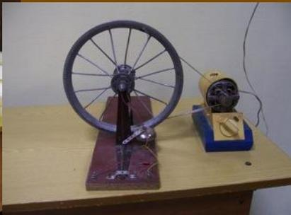
Установки позволяют определить период вращения тела осциллографом (самым дорогим прибором) или непосредственно. Колесо взято от велосипеда «Дружок», вентилятор – от автомобиля, фотодиод – из какой-то платы. Наноамперметр (Щ300) на рисунке нужен только для обучения пользоваться этим прибором, как и мультиметр Ц4311 с зеркальной шкалой.
