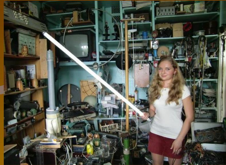
Мощность 40Вт идёт через человека. Напряжение 60кВ. Плазма и в лампе, и в стримере. Опытов с плазмой множество: разряды, ионные двигатели...
