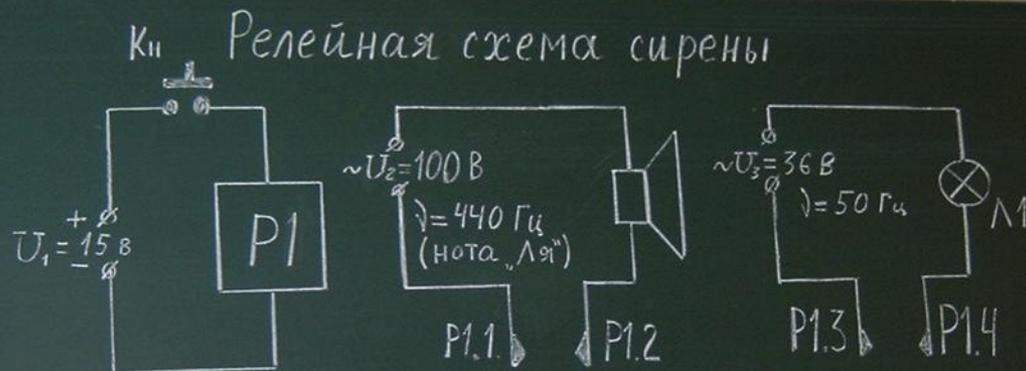
Каждый получает своё задание типа: разработать и собрать релейную схему, чтобы при нажатии кнопки загорелась лампочка 36В и загудела сирена питанием на 110В. Усваиваем разные каналы реле.
