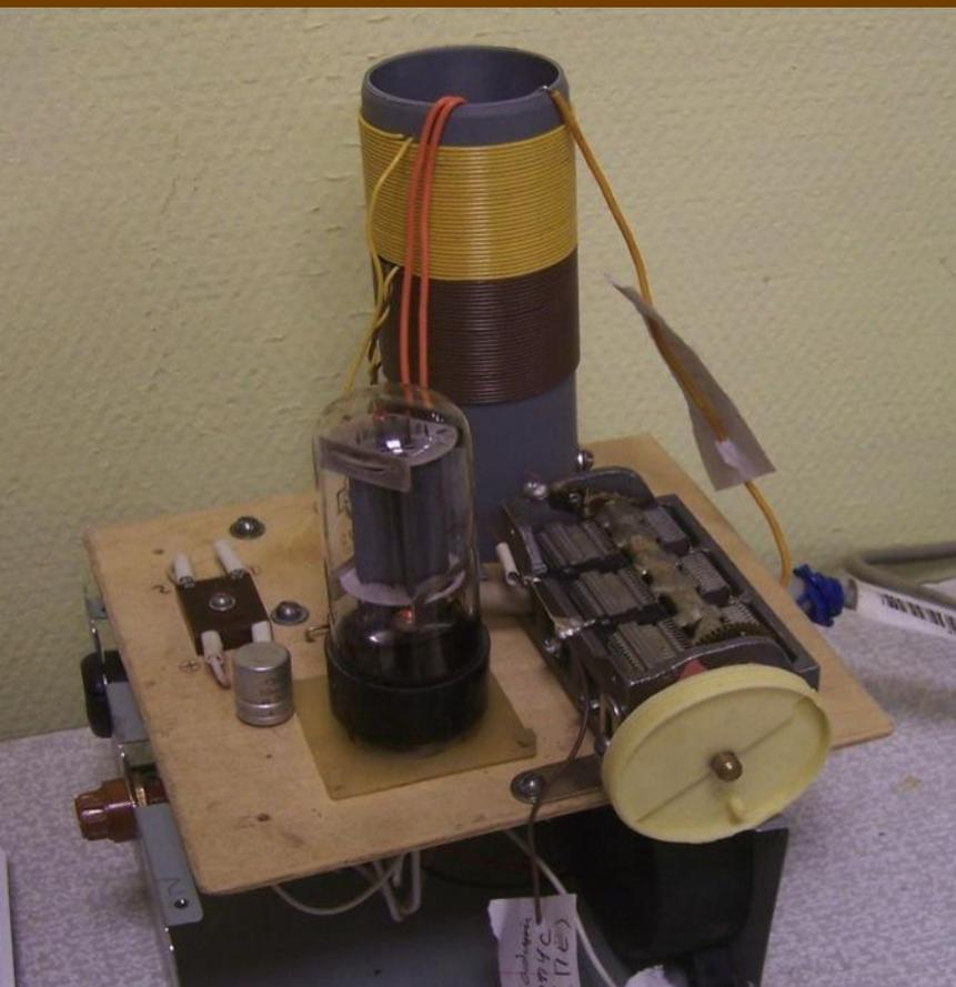
Амплитудный модулятор – школьный генератор низкой частоты ГЗШ-63. С антенной 10 метров глушит станции 300-350 м во всём городе (1 км).
