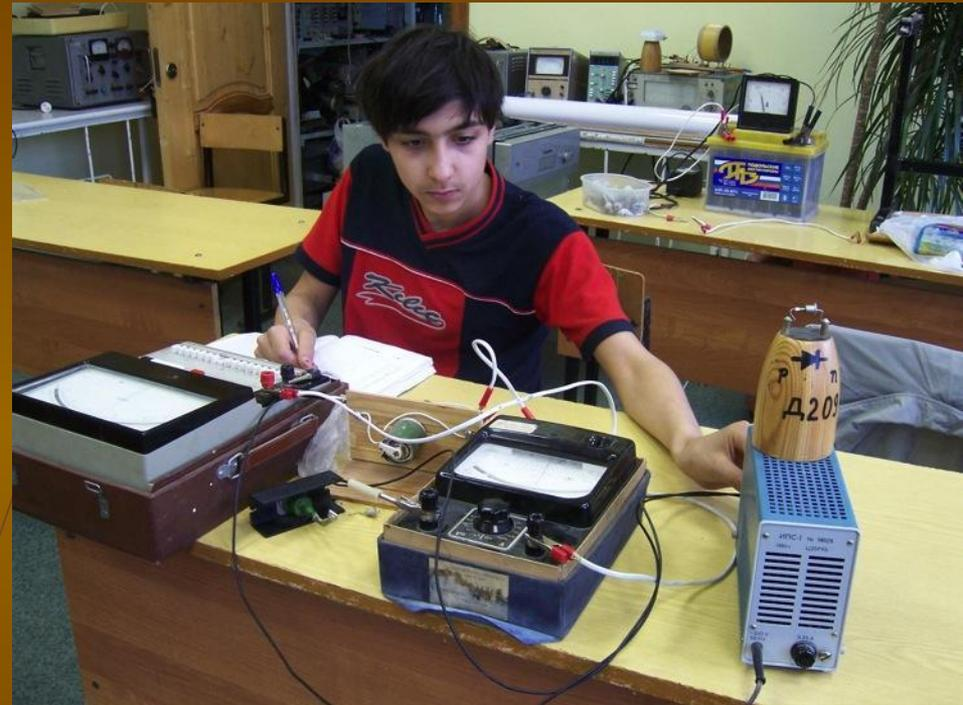
Лучший полупроводниковый диод для снятия ВАХ – Д204. Подставка самодельная из мебельной ножки, радиатор снят с какой-то платы. Исследуем также Д226, Д237, Д242, В50, 300-ю и 800-ю серии.
