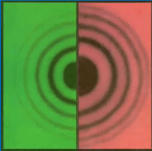
Рисунок 2. Кольца Ньютона в зеленом и красном свете.
