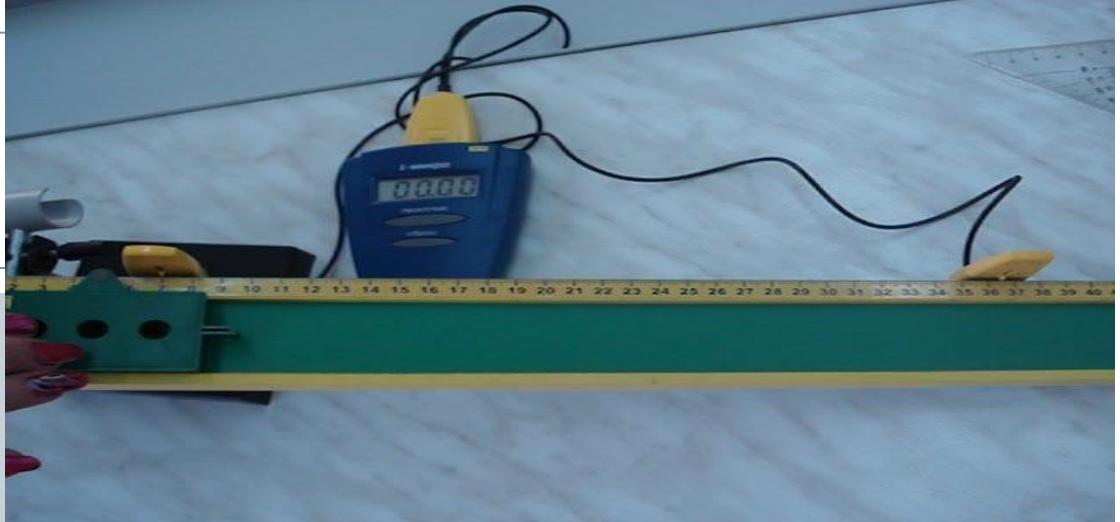
На рисунке представлена фотография установки для исследования скольжения бруска по наклонной плоскости. В центр бруска вставлен магнит. Числа на линейке обозначают сантиметры.
