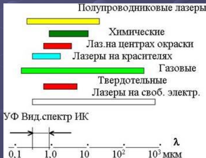
Рис. 2.1. Диапазоны длин волн генерации, перекрываемые действующими лазерами (кроме рентгеновских)
