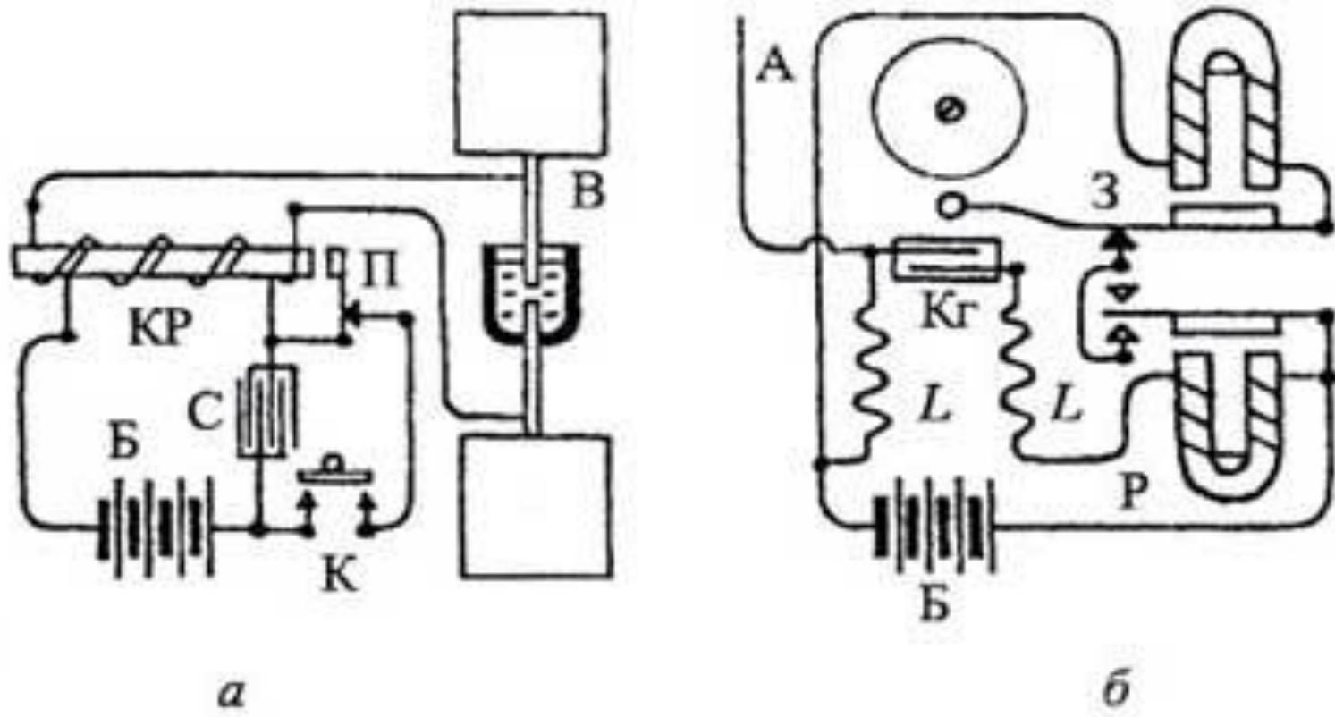
Рис.2. Схема первой искровой приемопередающей радиосистемы А.С.Попова, апрель-май 1895 г.:
