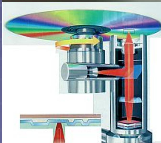
В проигрывателях лазерных дисков и в компьютерах используются полупроводниковые лазеры . Малая расходимость лазерного пучка позволяет получать с помощью оптических систем очень узкие световые пучки, необходимые для записи и считывания информации с очень высокой пространственной плотностью.
