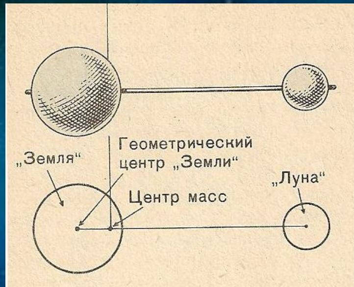
*Но вернёмся в космос. Проделанный опыт имеет прямое отношение к системе Земля-Луна. Роль стержня от шариковой ручки, который связывает шарики в нашем опыте, играет притяжение Луны к Земле и Земли к Луне. Центр масс этой космической системы Земля-Луна находится внутри земного шара на расстоянии 4700 км от геометрического центра Земли. За полный оборот Луны вокруг Земли геометрический центр Земли тоже делает один полный оборот вокруг центра масс системы Земля-Луна.*
