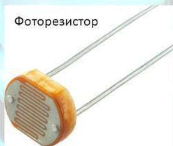
Сила тока зависит от интенсивности падающего света и сопротивления нагрузки  $R$
