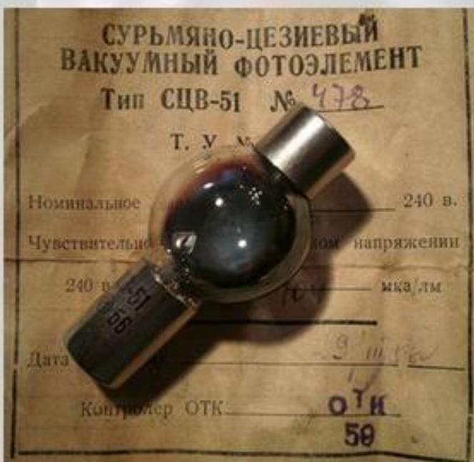
Фотоэлементы, использующие внешний фотоэффект, преобразуют в электрическую энергию лишь незначительную часть энергии излучения. Поэтому в качестве источников электроэнергии их не используют, зато широко применяют в различных схемах автоматики для управления электрическими цепями с помощью световых пучков.
