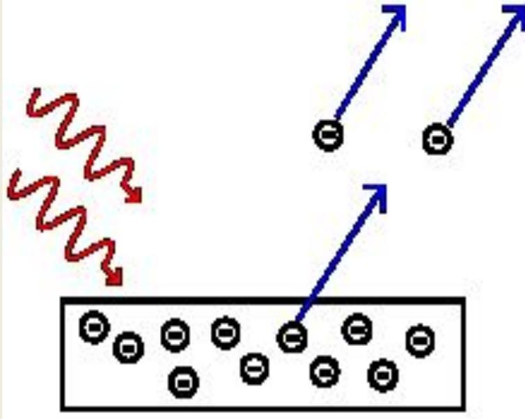
**Фотокатод** — электрод вакуумного электронного прибора, непосредственно подвергающийся воздействию электромагнитных излучений и эмитирующий электроны под действием этого излучения. Зависимость спектральной чувствительности от частоты или длины волны электромагнитного излучения называют *спектральной характеристикой фотокатода*.
