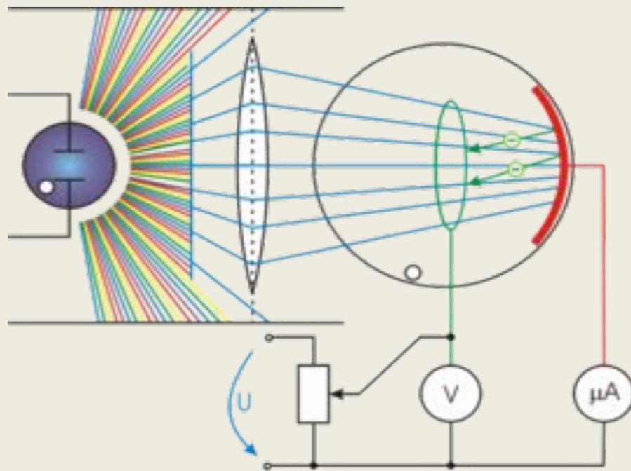
**Рис. 4.** Схема эксперимента по исследованию фотоэффекта
