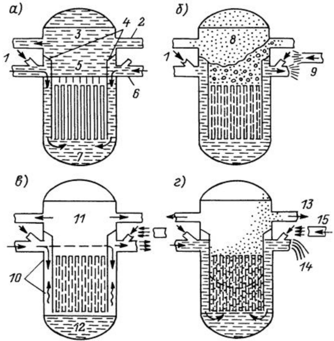
Рис. 7. Принципиальная схема развития МПА в корпусе реактора: *а* – нормальный рабочий режим; *б* – фаза разгерметизации; *в* – фаза повторного заполнения нижней камеры; *г* – фаза повторного заполнения активной зоны
