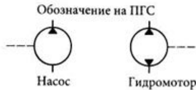
Рис. 4.1. Нерегулируемый аксиально-поршневой насос (гидромотор):
