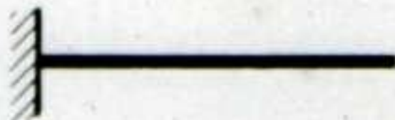
Неподвижное закрепление оси, стержня
