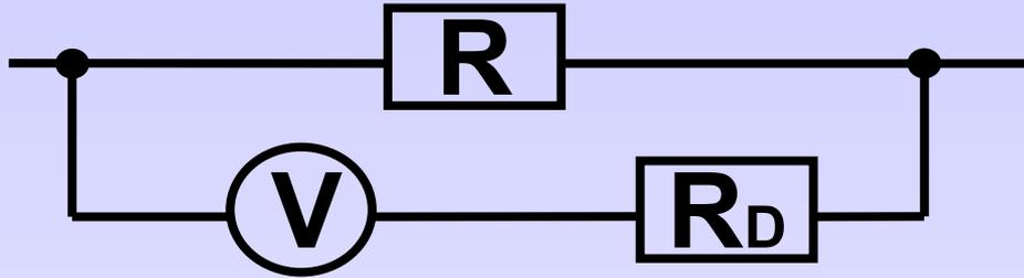
Если предел измерения вольтметра недостаточен для измерения напряжения на участке цепи, используется добавочное сопротивление – резистор, включенный в цепь последовательно с вольтметром. (Добавочное сопротивление предназначено для расширения предела измерения вольтметра).
