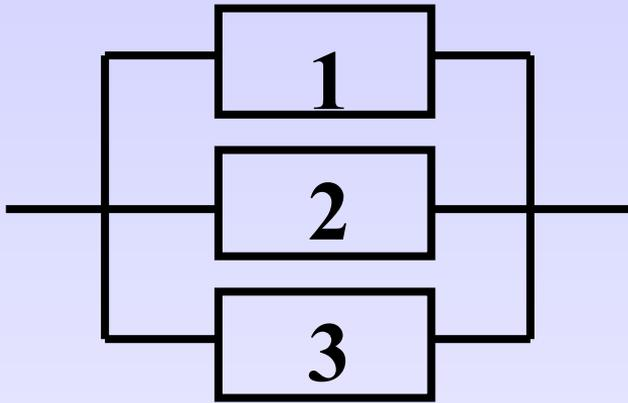
если  $R_1 = R_2 = R_3 = \dots$ , то  $R_{\text{общ}} = \frac{R}{N}$
