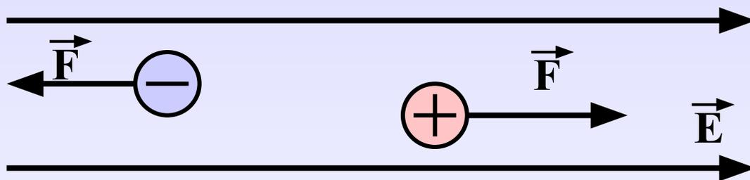
За **направление электрического тока** принято направление движения положительно заряженных частиц.
