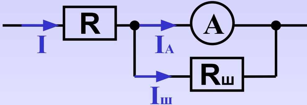
Если предел измерения амперметра недостаточен для измерения силы тока на участке цепи, используется шунт – резистор, включенный в цепь параллельно амперметру. (Шунт предназначен для расширения предела измерения амперметра).
