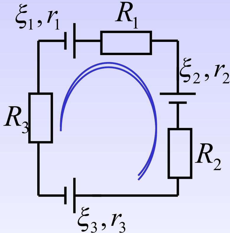
$$I = \frac{-\xi_1 \xi_1 - \xi_2 \xi_2 - \xi_3 \xi_3}{R_1 + R_2 + R_3 + r_1 + r_2 + r_3}$$
