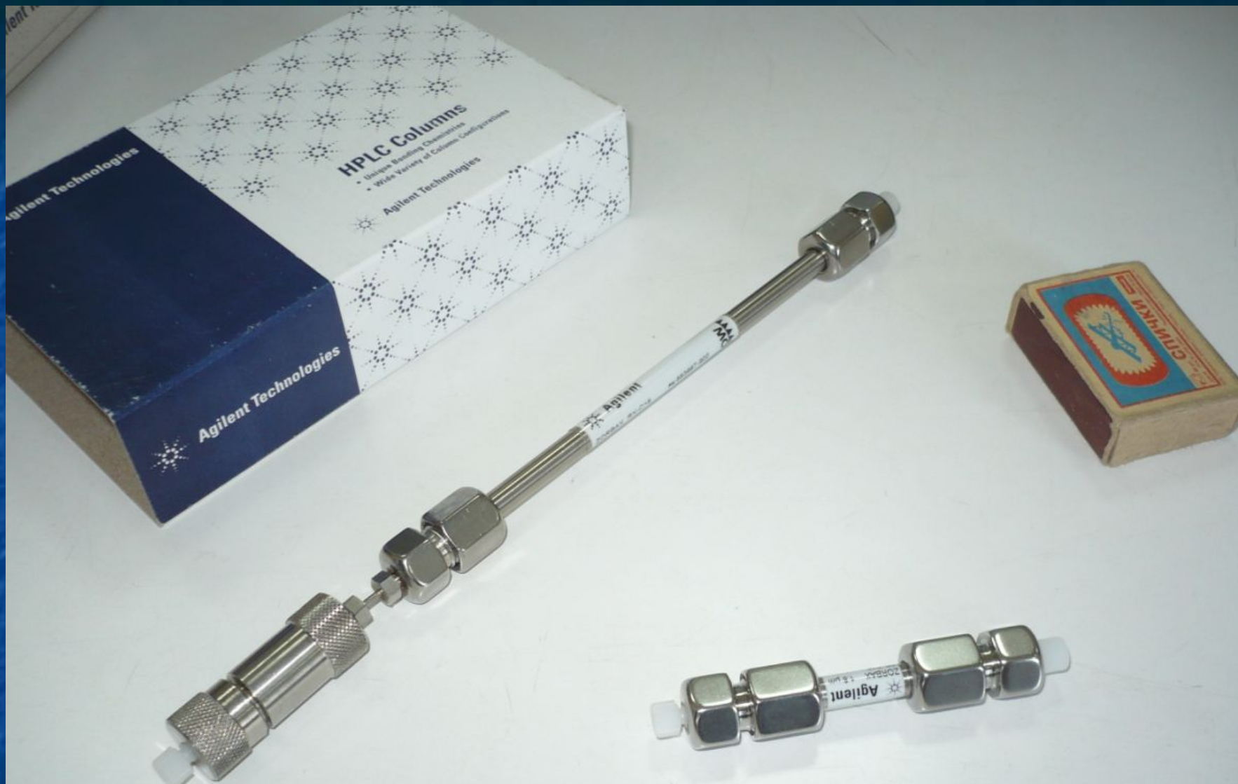
Рис. Капиллярные хроматографические колонки для жидкостной хроматографии, слева – аналитическая колонка диаметром 5 микрон с предколонкой, справа – аналитическая колонка диаметром 1.8 микрон
