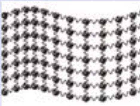
Наложение продольной и поперечной волн
