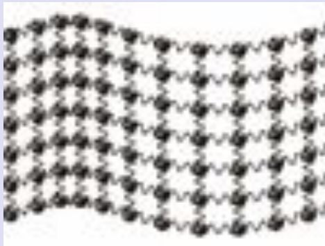
Наложение продольной и поперечной волн
