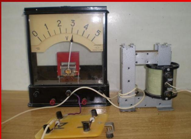
При увеличении числа витков во вторичной катушке и замыкании сердечника возрастает ток и напряжение вторичной катушки.
