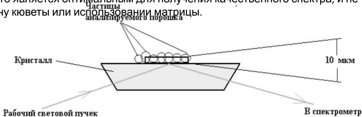
Схема измерения спектра порошка методом НПВО.
