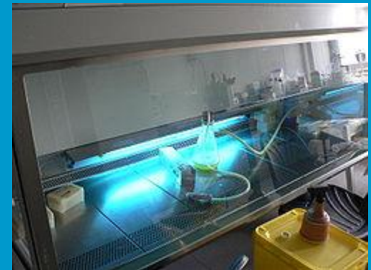
Кварцевание инструмента в лаборатории
