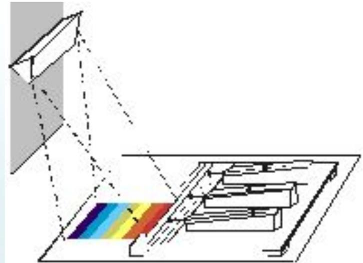
Термометр, помещенный за красной частью солнечного спектра, показал повышенную температуру по сравнению с контрольными термометрами расположенными сбоку.
