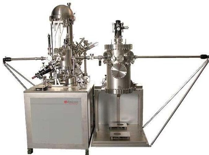
Рис. 1.2. Интегрированный сверхвысоковакуумный комплекс для исследования топографии и физико-химических свойств поверхности твердых тел
