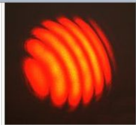
Интерференционная картинка на выходе интерферометра
