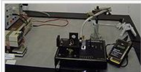
Современный интерферометр Майкельсона
