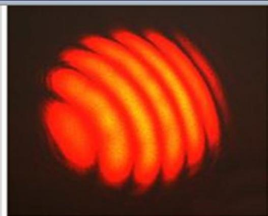
Интерференционная картинка на выходе интерферометра
