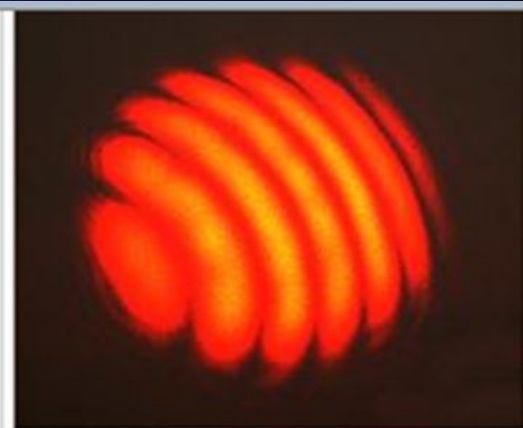
Интерференционная картинка на выходе интерферометра
