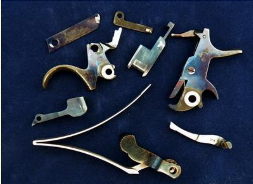
Цвета побежалости при термообработке стали
