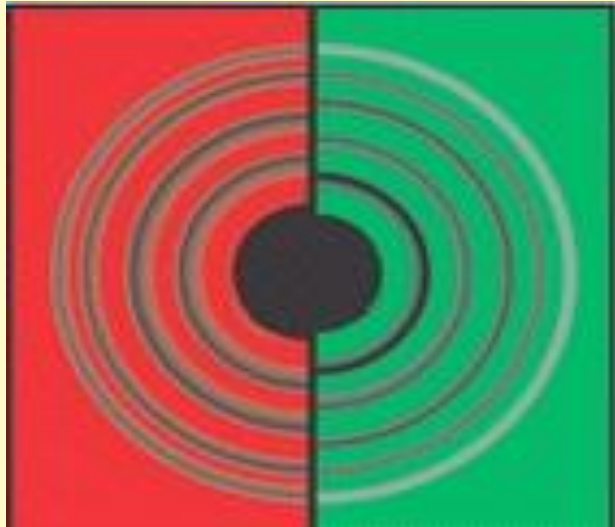
Кольца Ньютона в монохроматическом свете
