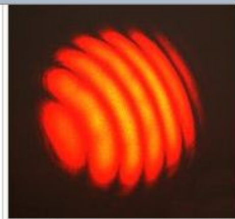
Интерференционная картинка на выходе интерферометра
