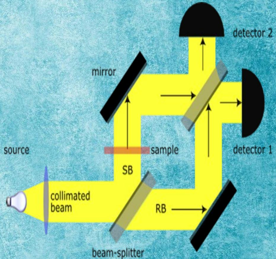
Схема интерферометра Маха — Цендера
