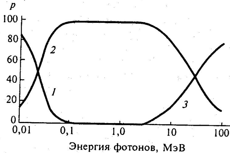
Рис. 4.2. Относительная вероятность, %, поглощения фотонов различной энергии ( E ) в одном из трех видов взаимодействия излучения с веществом: 1 — фотоэффект, 2 — комптон-эффект, 3 — процесс образования пар
