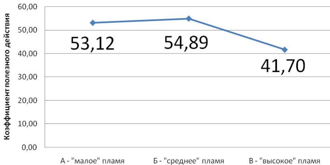
Зависимость КПД горелки от высоты пламени для горелки №3 и сосуда II
