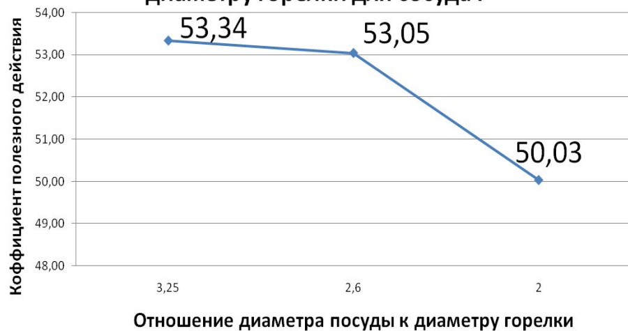
Зависимость КПД горелки при среднем пламени от соотношения диаметра посуды к диаметру горелки для сосуда I
