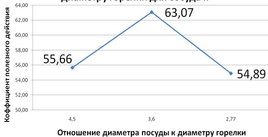
Зависимость КПД горелки при среднем пламени от соотношения диаметра посуды к диаметру горелки для сосуда II
