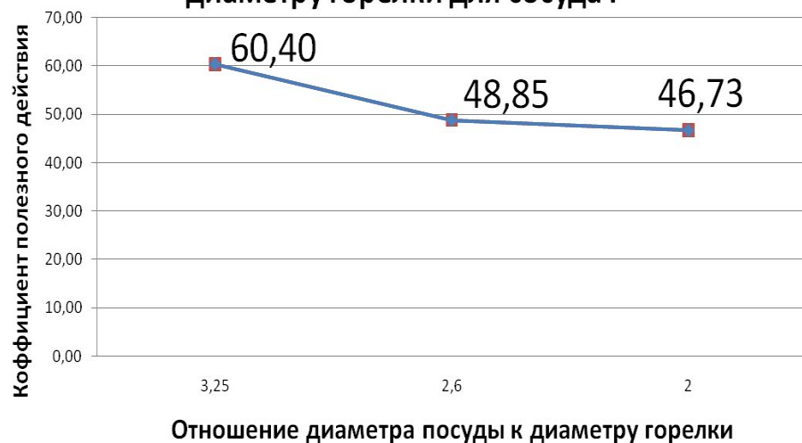
Зависимость КПД горелки при малом пламени от соотношения диаметра посуды к диаметру горелки для сосуда I
