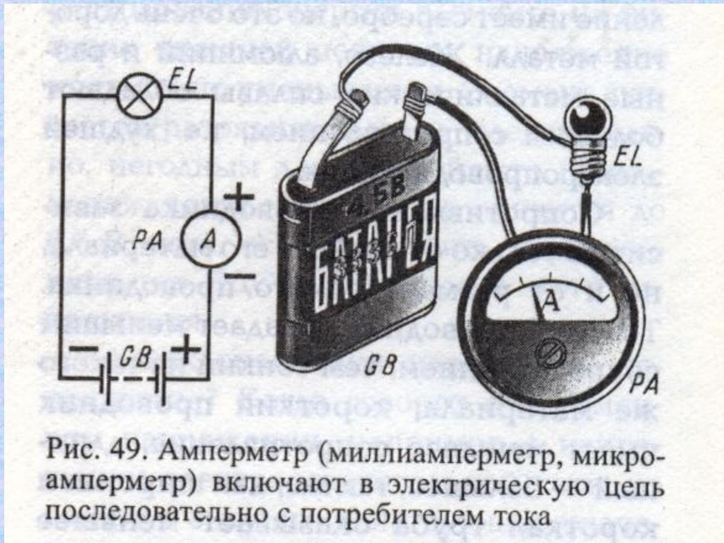
Рис. 49. Амперметр (миллиамперметр, микроамперметр) включают в электрическую цепь последовательно с потребителем тока
